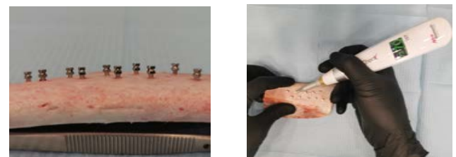
Рис. 9. Фото мініімплантів із зануренням шийки на 1 мм у кістку (а) та їх вимірювання (б)
