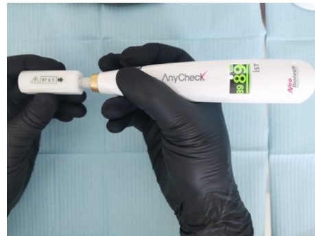
Рис. 7. Зображення етапу калібрування апарату Anycheck
